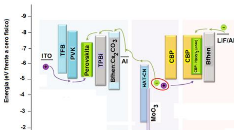
Figura 14. Diagrama de niveles energéticos del dispositivo híbrido emisor de luz representado en la Figura 13. Los valores de los niveles energéticos pueden verse en (Science 332, 944-947, 2011).
