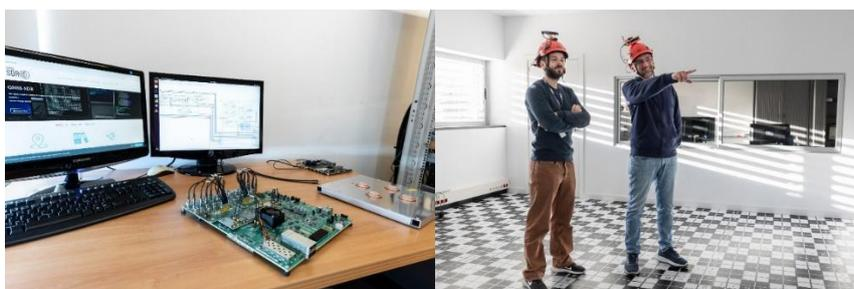
*Figura 5. Prototipo de receptor GNSS y array para la detección de interferencias en GNSS desarrollados en el CTTC (izq); espacio de pruebas y medidas para el posicionamiento en interiores (dcha.).*
