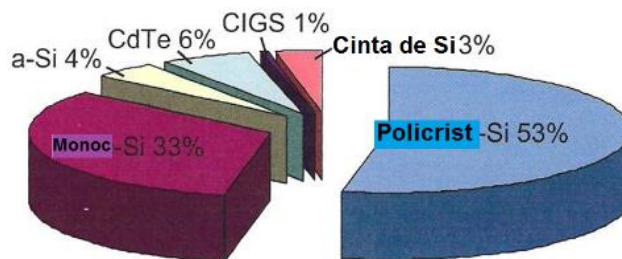
Figura 9. Tanto por ciento de diversos tipos de células solares existentes en el mercado en 2007 (CIGS = \text{CuIn}_x\text{Ga}_{1-x}\text{Se}_2 a-Si = silicio amorfo).
