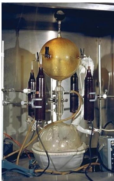
Figura 7. Experimento de Miller. Reproducción del aparato original y esquema del mismo.
