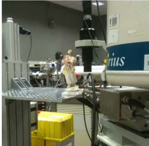
Figura 2. Figura pequeña de porcelana cedida por el Museo Arqueológico Nacional durante su estudio con la línea del Microhaz Externo utilizando la técnica PIXE. En esta imagen el haz se encuentra a la altura del pedestal de la imagen, así como los detectores de rayos X.
