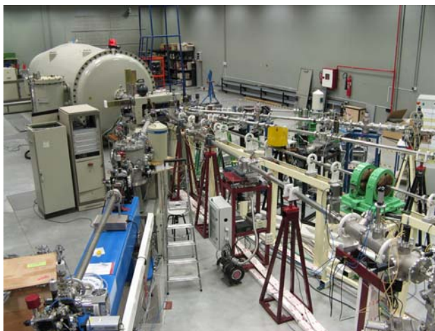
Figura 1. Vista del interior de la sala experimental con el acelerador al fondo y las líneas de haz emergiendo del imán conmutador. La magnitud del campo magnético generado en este imán determina la deflexión que experimentará la trayectoria de los iones y por lo tanto la línea a la cual irán.
